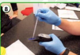
Проверка удельной плотности
